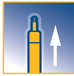
With piston rod upwards Kolbenstange nach oben
